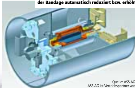
Die Wirkamplitude wird durch die Verstellung der Unwuchten gegeneinander in der Vibrationseinheit der Bandage automatisch reduziert bzw. erhöht.
