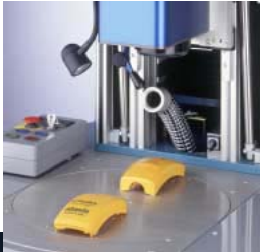
Beim Takten des Drehtisches sorgen HFUC-2UH-Units für die erforderliche Präzision.
