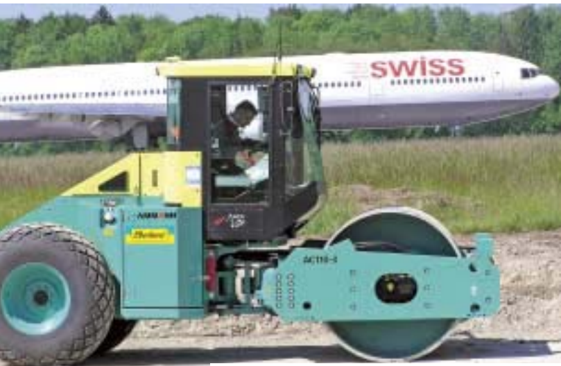
Mit ACE werden optimale Verdichtungsresultate erreicht und Verdichtungszeiten deutlich reduziert. Parallel zum Verdichtungsvorgang wird automatisch eine flächendeckende Verdichtungskontrolle (FDVK) durchgeführt.
