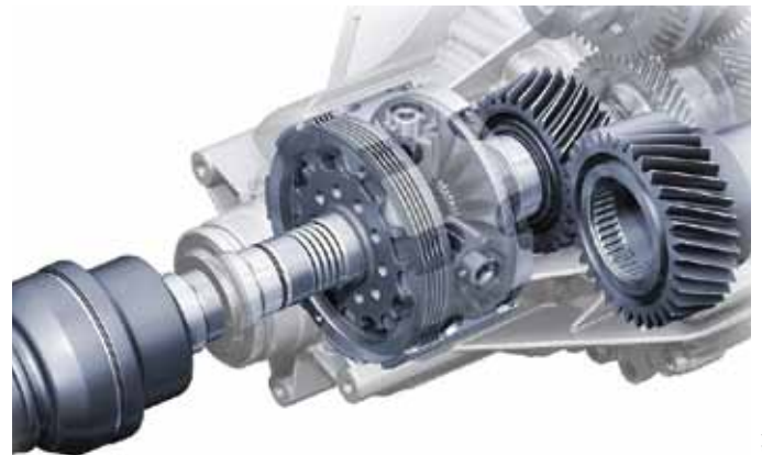
Mittendifferenzial des Audi quattro RS5, mit zwei «Cylkro»-Kronenrädern und vier Ausgleichsritzeln.
