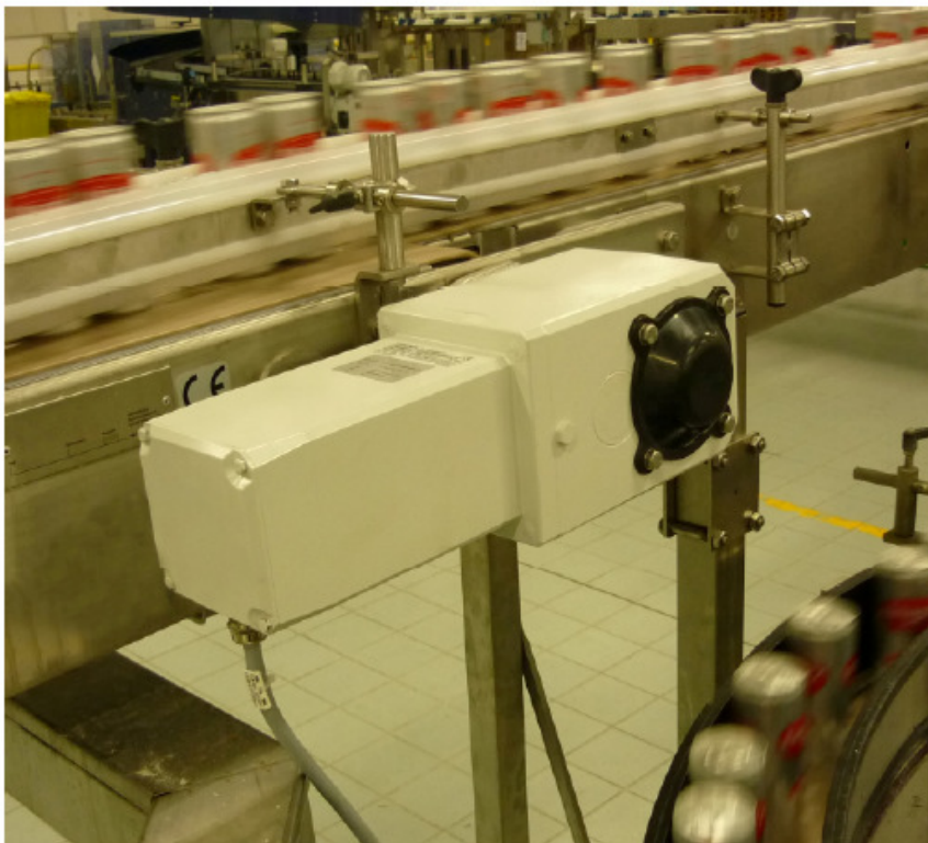
Bild 7: Wirkungsgradoptimierter Getriebemotor im Einsatz beim Kunden
