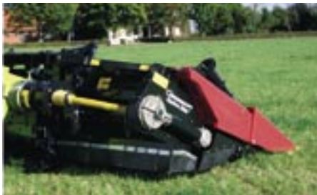
Bild 2: Kronenradantrieb im Maispflückvorsatz
