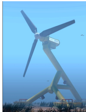
Bild 1: Die Ausrichtung der Flügel von Gezeitenkraftwerken mit Kronenrädern ermöglicht eine wesentlich höhere Energieausbeute.
