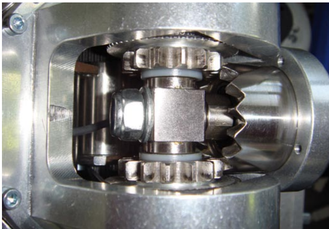
Eulerhand mit Kronenradgetrieben.
